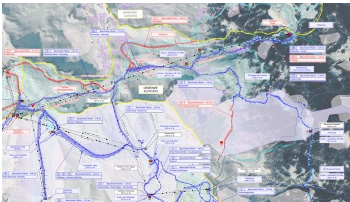
Abbildung 1: Übersicht über das Skigebiet Parsenn, Gemeindegebiet Klosters. In Rot sind die geplanten Beschneigungsanlagen, in Blau der Bestand eingezeichnet.
