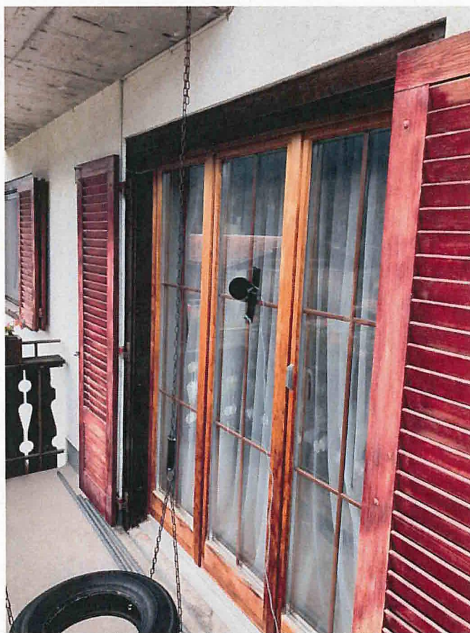
Abbildung 3: Position des Messmikrofons auf der geschlossenen Balkontüre im ersten Stock.
