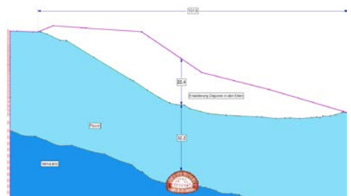
Berechnungsschritt 5, 40% Stützdruck, 60% Vorentlastung
