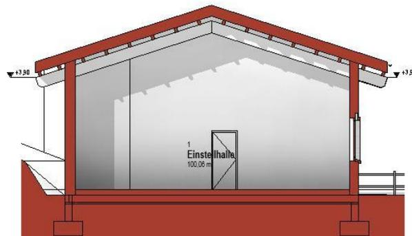
*Abb. 6: Schnitt Fahrzeughalle*
